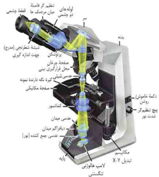
شکل ۳-۱. اجزای یک میکروسکوپ زمینه روشن و مسیر نور در آن.
